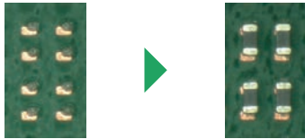
Soldadura después de impresión
